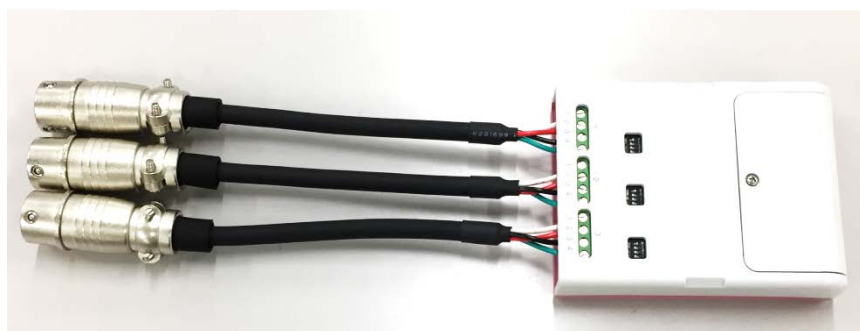
NDIS ケーブル接続例
