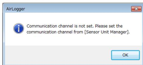
PC側通信ユニットの通信周波数チャンネルの設定が初期状態(出荷時)のままなので、設定を行う必要があります。[OK]ボタンを押すと、測定ユニット管理ウィンドウ(6.1節を参照)が出てきますので、通信周波数の設定(6.5節を参照)を行ってください。
