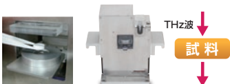
▲透過モジュールの試料ホルダ部(ドライエアバージ機能付)
