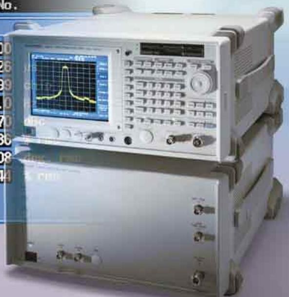
R3562は、W-CDMA(3GPP)cdma2000(3GPP2)の無線フレームを発生できるレシーバ・テスト・ソースです。移動機および基地局との同期確立に必要な各種クロック入出力を装備しているため、容易に同期確立し、内蔵のビット・エラー・レート(BER)カウンタで受信感度試験を実現できます。また、3GPPでは送信電力制御信号(TPC)を付加することができるため、スペクトラム・アナライザR3267/3273と組み合わせることにより、電力制御ステップや可変範囲の確認および過渡特性評価ができます。
