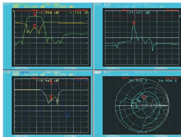
デュプレクサのTx.Rx.アイソレーション同時表示
