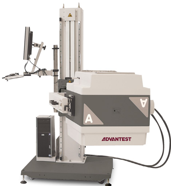
▲「Wave Scale™」等のモジュールを使用する「V93000」テスト・システム(写真はAクラス)
